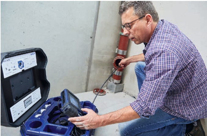
Das hoch auflösende Display zeigt es in aller Deutlichkeit: Irgendwer hat irgendwann eine querende Rohrleitung durch das KG-Rohr gelegt ... Per Schnappschuss-Funktion wird der Mangel als Foto gesondert dokumentiert.
