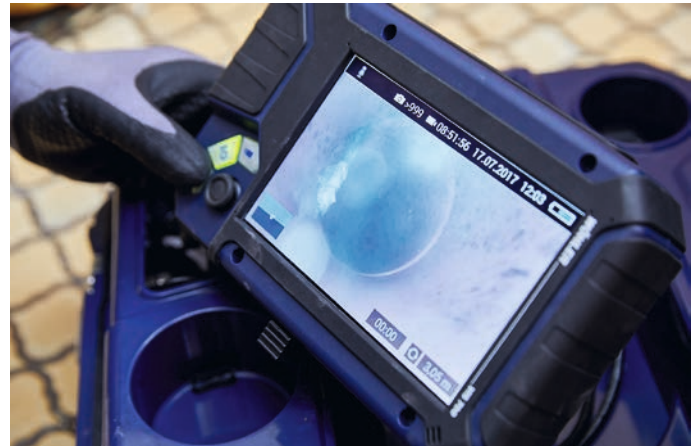
Das hoch auflösende Display zeigt es in aller Deutlichkeit: Irgendwer hat irgendwann eine querende Rohrleitung durch das KG-Rohr gelegt ... Per Schnappschuss-Funktion wird der Mangel als Foto gesondert dokumentiert.
